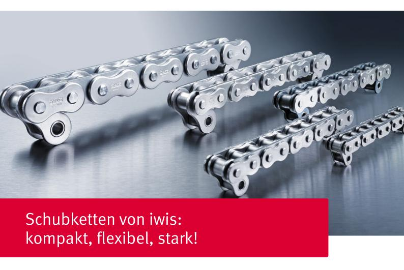
**Chain Engineering für den kleinsten Bauraum:** iwis-Schubketten zeichnen sich durch eine kompakte Bauweise aus. Sie eignen sich zur Übertragung von Druck- und Zugkräften, für die eine Kettenführung nicht notwendig ist.
