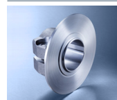
Reibscheibe aus Grauguss fertig gedreht mit Teilungsschnitt für flexible Befestigung auf der Welle
