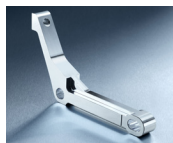
Hebelarm als Kettenanbauteil für Lagersysteme gefertigt aus Schmiederohling, mechanisch bearbeitet, verzinkt Wird zusätzlich mit Gleitlagermontage und montierter Kunststoffkappe zur Baugruppe montiert
