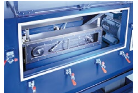
Zincir yıpranma uzaması davranışının test edilmesi 20'den fazla test platformunda yapılır.
