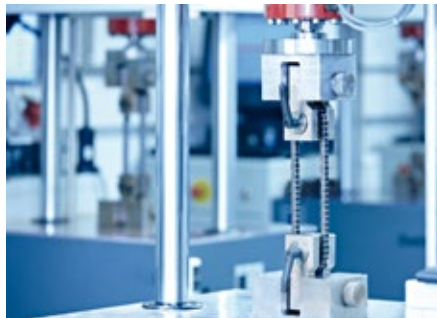
Farklı test yöntemlerine göre dinamik yorgunluk dayanımı testleri için 25'den fazla pulser mevcuttur.
