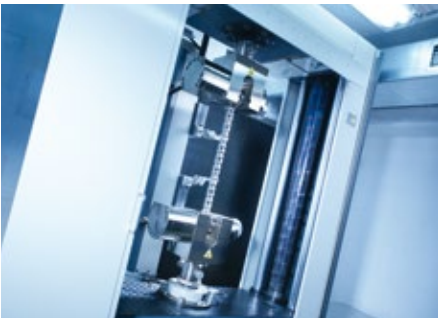
Zincir kopma dayanımının ve 1000 kN'ye kadar esnemenin değerlendirilmesi.
