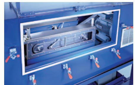
Etude du comportement à l'usure sur plus de 20 bancs d'essai ainsi que des tests adaptés aux besoins et aux applications de nos clients Verifica del comportamento di usura su oltre 20 banchi di prova con attrezzature specifiche per catene agricole
