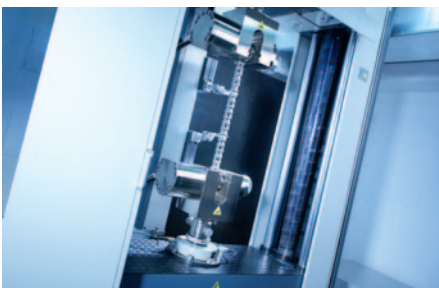
Bruchkraftermittlung und Dehnungsaufnahmen bis 1000kN Evaluation of chain breaking strength and elongation up to 1000kN
