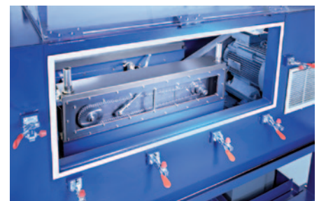
Untersuchung des Verschleißverhaltens auf mehr als 20 Prüfständen und kundenspezifische Testeinrichtungen für Landmaschinen Testing of chain wear elongation behaviour on more than 20 test rigs and customized facilities for agricultural chains
