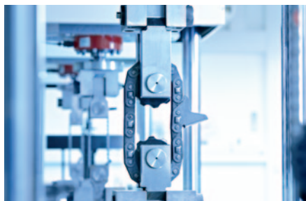
Dauerfestigkeits- und Zeitfestigkeitsüberprüfungen durch mehr als 15 Pulsatoren nach unterschiedlichen Prüfungsverfahren More than 15 pulser are available for testing dynamic fatigue strength according to different testing methods
