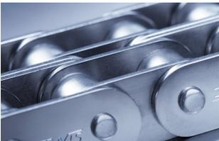
Wartungsfreie MEGAlife Rollenketten verfügen über nahtlose Sinterhülsen aus speziell für diese Anwendung entwickelten Werkstoffen, nahtlose Rollen mit korrosionsgeschützter Oberfläche sowie Bolzen mit verschleißfester und reibungsoptimierter Oberflächenbeschichtung.
