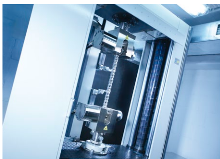
Vyhodnotenie sily pretrhnutia reťaze a jej predĺženia do 1000 kN
