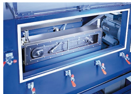
Testovanie predĺženia spôsobeného opotrebením na viac ako 20 testovacích zariadeniach
