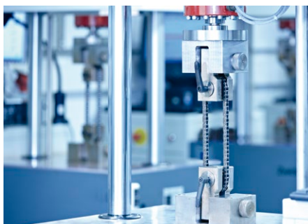
Viac ako 25 pulzátorov je k dispozícii na testovanie dynamickej únavovej sily podľa rôznych testovacích metód
