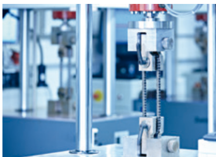
K dispozici je více jak 25 pulzátorů pro testování dynamické únavové síly podle různých testovacích metod
