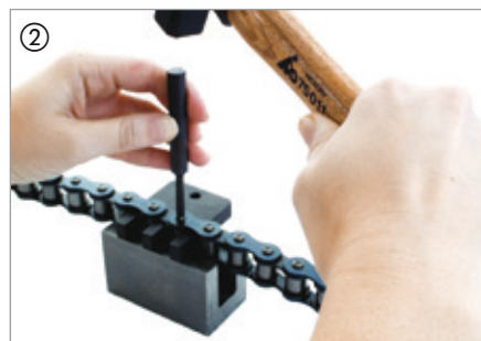
Řetězový článek s přečnávajícím čepem
