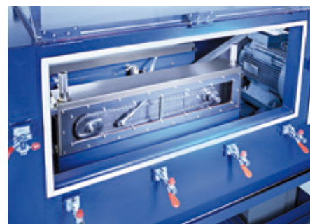
Testování prodloužení způsobeného opotřebením na více než 20 zkušebních zařízeních
