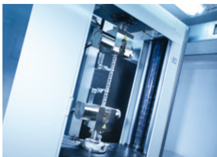
Vyhodnocení síly přetržení řetězu a jeho prodloužení do 1 000 kN
