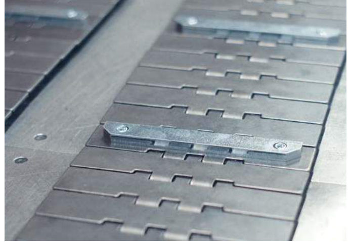
Modifizierte Scharnierbandketten mit Mitnehmern Modified Flat Top Chains with attachments
