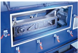
20'den fazla teçhizatla zincir yıpranma esneme davranışının test edilmesi.
