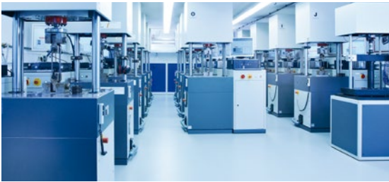
21'den fazla pulser cihazı farklı test yöntemlerine göre dinamik yorgunluk dayanımını test etmek için hazırdır.
